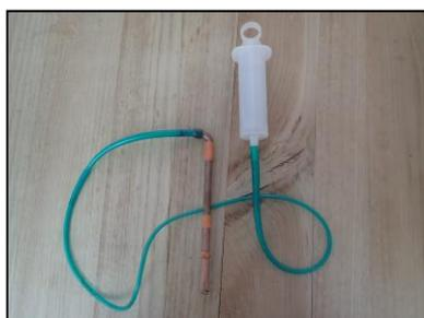
Figure 36 : Dispositif de prélèvement d'eau interstitielle
