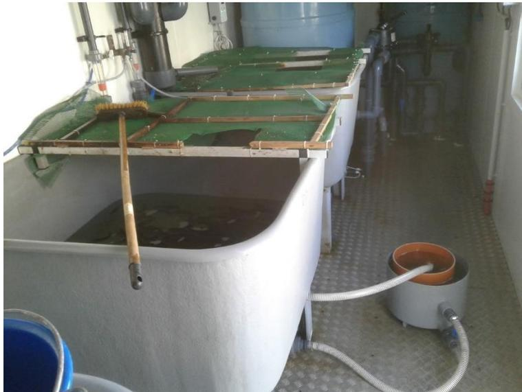
Figure 12 : Filtration d'un bac truitelle à l'aide d'un tamis 150 microns (photo Alexis RACHER)
